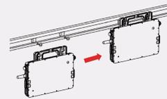
*\*Hinweis: Installieren Sie den Mikro-Wechselrichter mindestens 50 cm über dem Boden/Dach, um eine bessere Kommunikation mit der DTU von Hoymiles ermöglichen*
