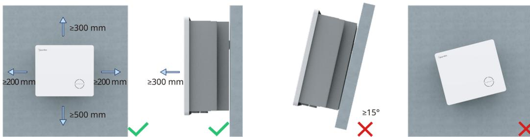
4. Der Wechselrichter sollte in einer Umgebung mit guter Belüftung und Wärmeableitung installiert werden.
